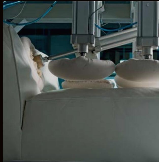
Edra teste ses produits avec des machines conçues spécialement pour chaque caractéristique et physionomie. Certains tests prévoient la simulation de dizaines d'années d'utilisation plusieurs fois par jour. Sur la photo, un canapé Sofà est comprimé afin d'écraser les cellules fermées des masses rembourrées. **Mod. Sofà**
